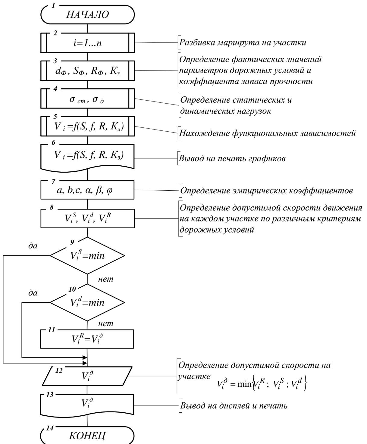
Рисунок Д.2 - Блок-схема алгоритма определения и выбора оптимальных режимов движения большегрузного автопоезда
