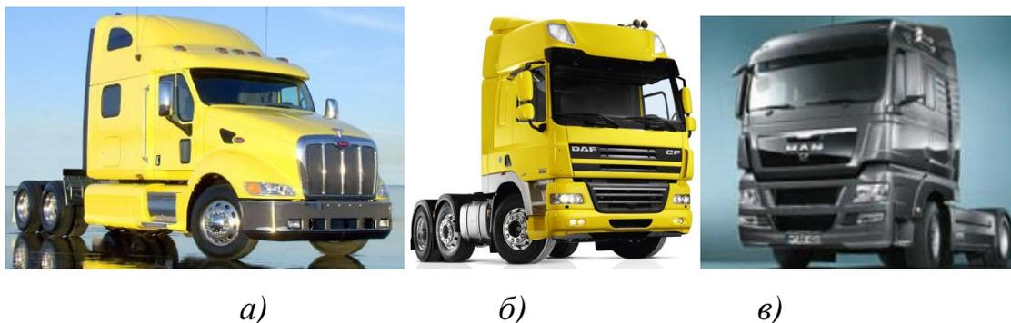
Рисунок 3.4 – Седелные тягачи: *а* – 3-х осный тяжелый седельный тягач капотной компоновки; *б* - 3-х осный седельный тягач бескапотной компоновки; *в* - 2-х осный седельный тягач капотной компоновки
