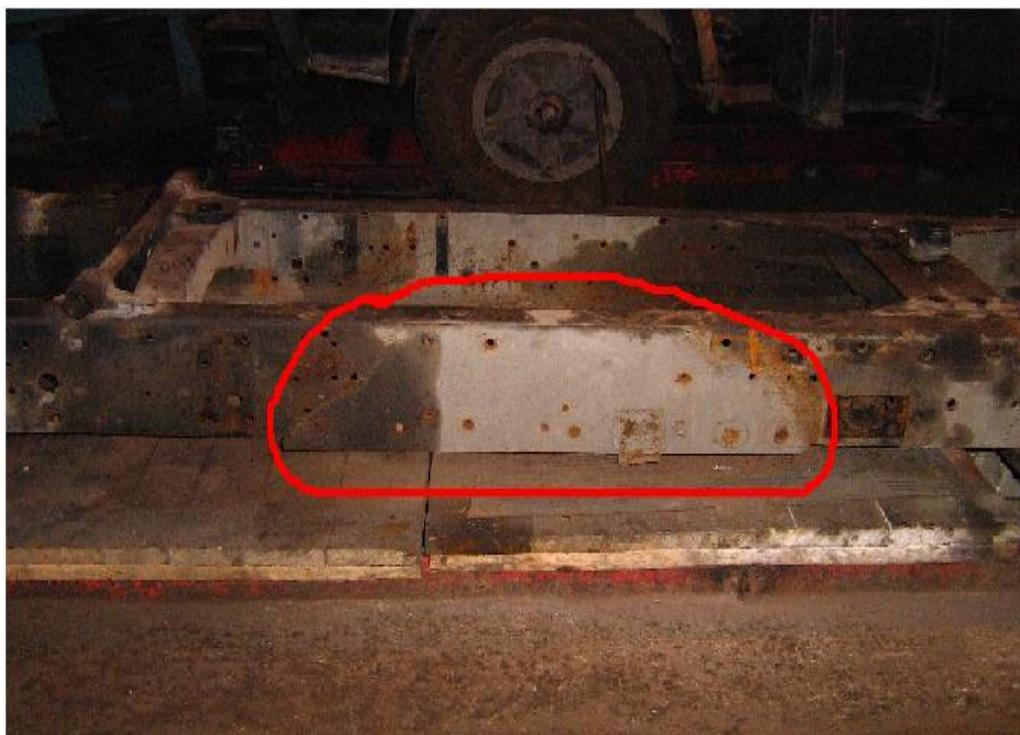
Рисунок А.2 - Восстановленный участок лонжерона рамы тягача КАМАЗ-54115 в зоне седельно-сцепного устройства
