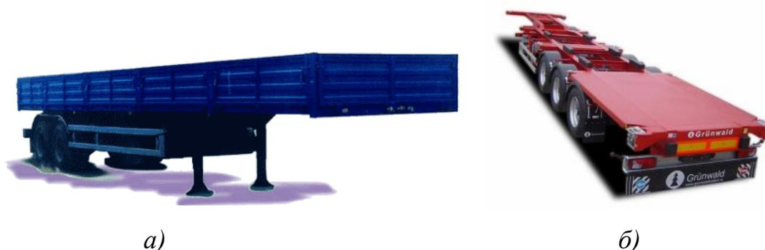
Рисунок 3.5 – Полуприцепы, используемые для перевозки металлопродукции: *а*) – бортовая платформа; *б*) - платформа без бортов
